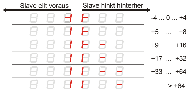
Funktion der Balkenanzeige in Abhängigkeit des aktuellen Winkelfehlers Das Bild zeigt positive Abweichungen. Negative Abweichungen sind spiegelbildlich.
